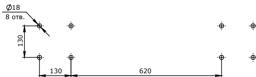
Присоединительные размеры двустоечной колонны
