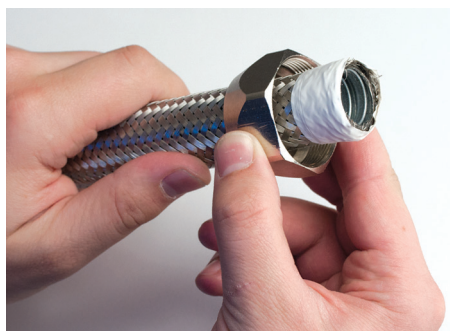
1. Вначале следует надеть на металлорукав зажимную гайку
