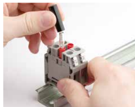
3. Закрепите прижимным винтом проводник в щупе
