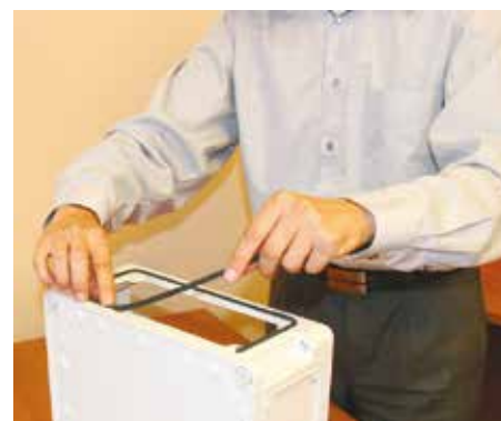
3. Установите уплотнитель на оба объединяемых корпуса
